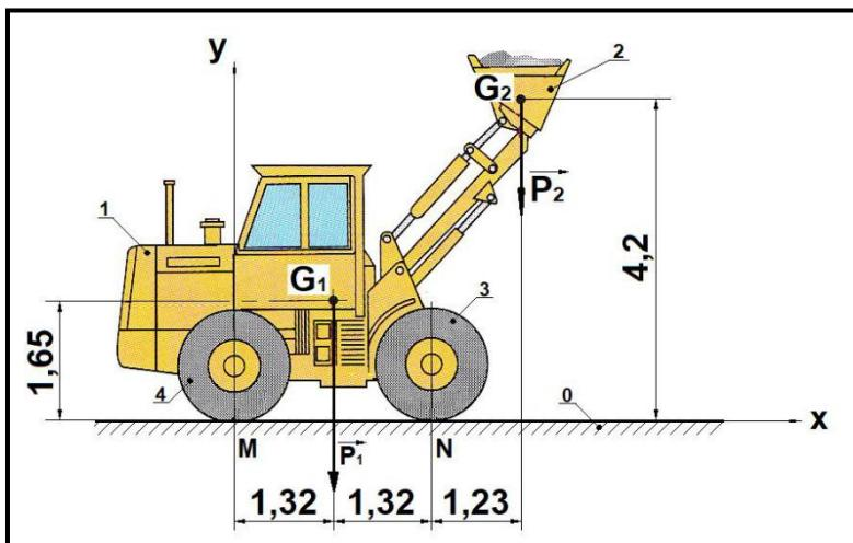
**Objectif** : déterminer les actions au niveau du contact entre les roues et le sol sachant que la masse du chargeur est de 12 500 Kg et la masse du godet + chargement est de 5 000 Kg.
